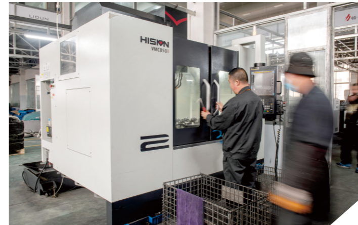
加工中心 Machining Center
